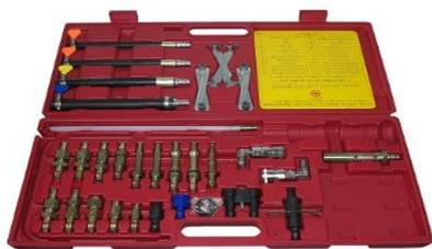
Данный набор включает в себя все необходимые переходники под различные марки и модели автомобилей, которые обеспечат Вас удобной и полноценной работой на установке для замены масла и промывки АКПП с системой измерения веса и температуры масла GrunBaum ATF 5000.
